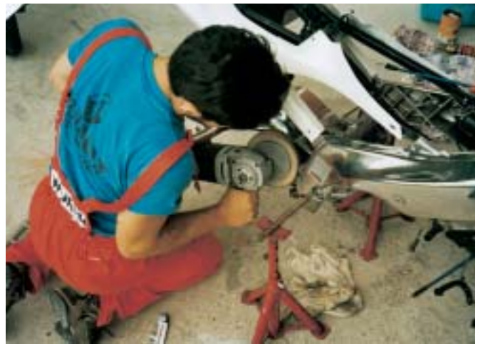
Nel proprio box casalingo, William procede alla gravosa opera di lucidatura del telaio in lega leggera e del forcellone posteriore.
