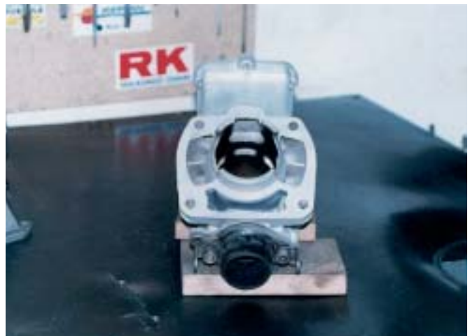
Possiamo notare le accurate lavorazioni degli imbrocchi dei travasi (si è curato molto l'accoppiamento con i carter) e dell'aspirazione.
