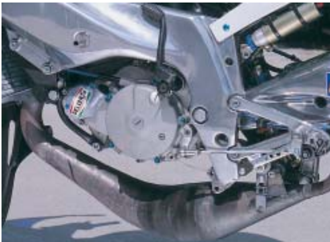
Il coperchio sinistro è stato sostituito dall'elemento dell'RX, dotato di kickstarter e di coperchio frizione amovibile indipendentemente.
