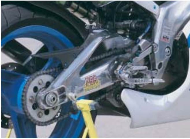
La trasmissione finale è stata sostituita da componenti che sfruttano la tecnologia delle corse, per ridurre l'assorbimento di potenza.
