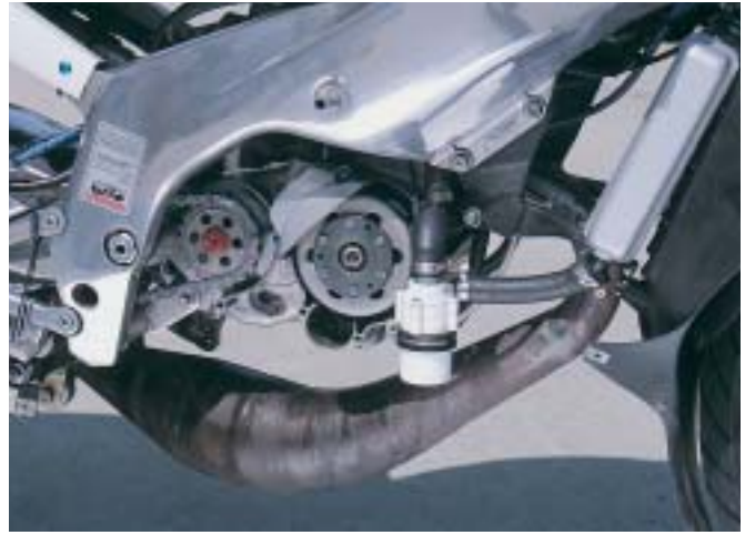
Per lo stesso motivo la pompa originale è stata sostituita da un'unità elettrica. L'espansione dello scarico è una Jolly Moto.
